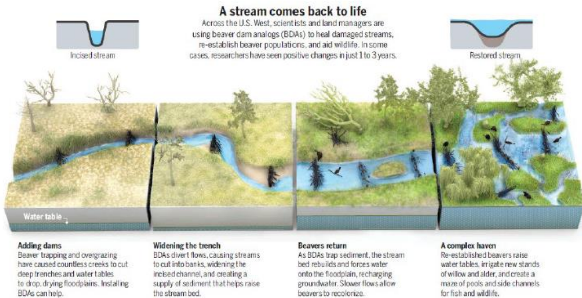
Stades évolutifs d'une rivière après la mise en place d'ouvrages castor
